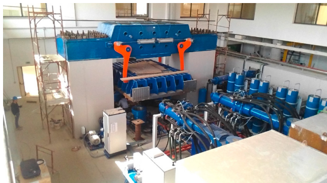
FIGURA 2 Il banco di prova per dispositivi antisismici (ASD Test Facility) di EUROLAB
