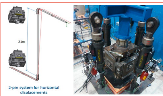
FIGURA 14 Giunti di espansione sviluppati nell'ambito del progetto SILER dal partner BOA e testati presso il laboratorio ELSA del JRC di Ispra. La corretta disposizione di 2 giunti permette di assorbire, nella tubazione che porta il vapore dal reattore ELSY alla turbina, spostamenti relativi orizzontali fino a 90 cm Per gentile concessione di BOA e JRC Ispra
